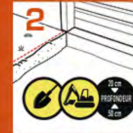
2 Préparation du fond de forme
