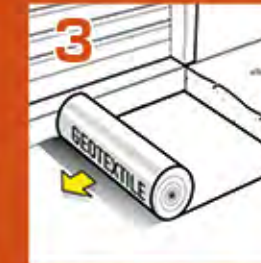
Mise en place du géotextile
