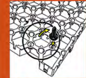
Pour la pose en pente, découper et utiliser les picots d'ancrage en les positionnant au dos de la plaque.
