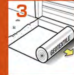
3 Mise en place du géotextile
